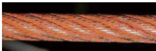
図 4-11 摩耗粉が付着した状態の例
